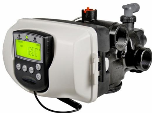
Ecran matriciel LED, saumurage et régénération proportionnel possible, contact programmable pour relai de sortie défaut régénération GTC/ODYBOX, régénération à contre ou co-courant, mode Micro-processeur fiable à réglage facilement accessible en façade, sauvegarde de l'heure et de la programmation de la dureté pendant 2 heures lors d'une coupure de courant, design modulaire, assemblage sans vis, alarme de sel théorique, gère au mieux la consommation de sel (signal niveau de sel faible)
